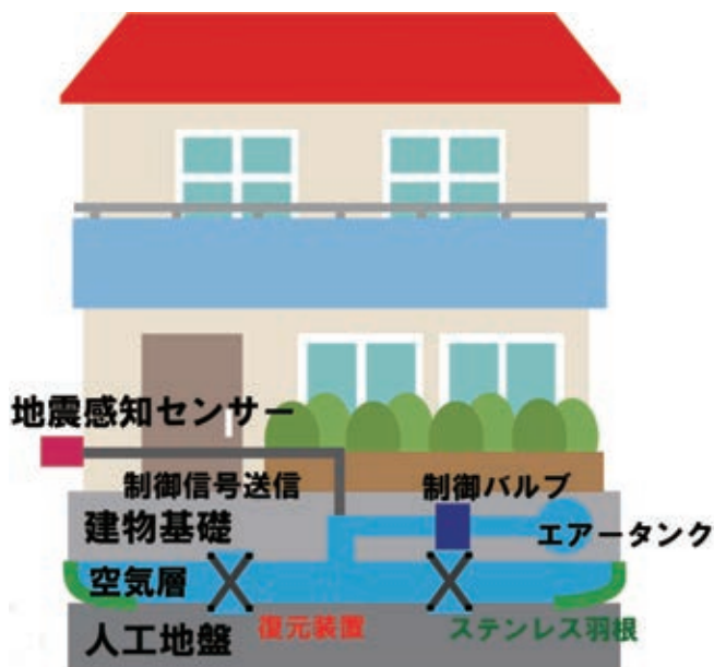
空気浮上免震の構造システム
