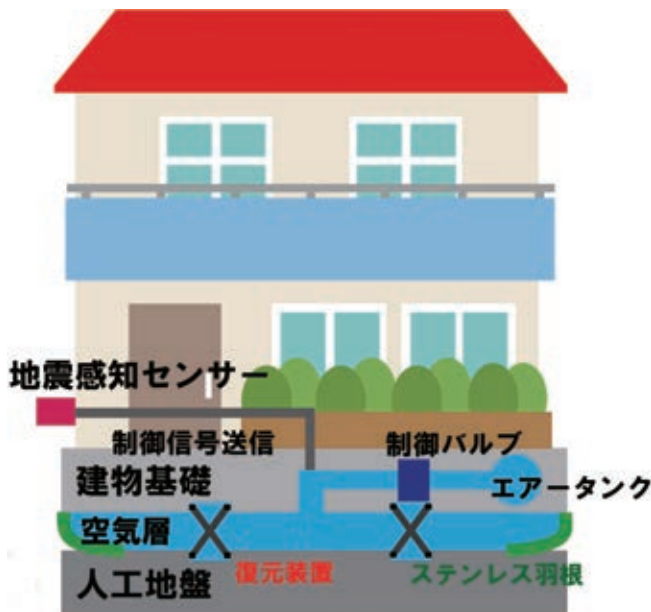
空気浮上免震の構造システム
