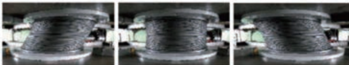
積層ゴムの圧縮せん断試験
