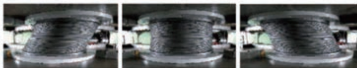
積層ゴムの圧縮せん断試験
