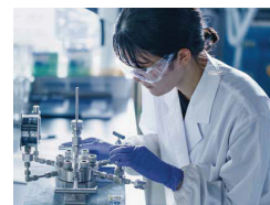
ステンレス製の高压反応器を使用して実際に重合している様子
