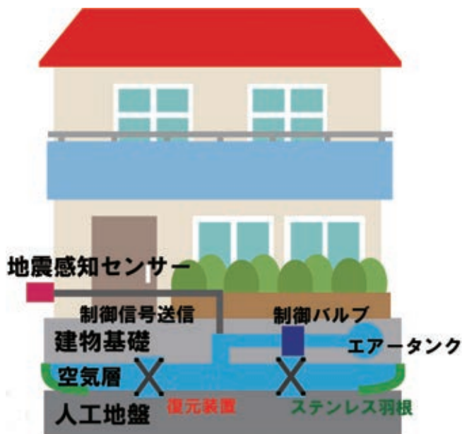
空気浮上免震の構造システム
