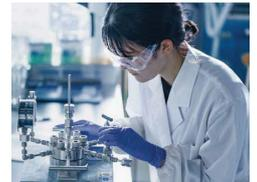
ステンレス製の高压反応器を使用して実際に重合している様子
