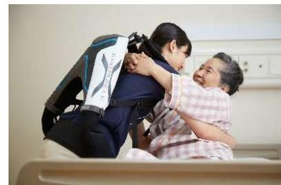
※腰部を補助するために、下半身に対して上半身を回転させる(すなわち、上半身を伸展させる)力を補強します。この回転力(トルク)の最大値はモデルによって異なり、100Nmから140Nmです。これは、腰部を中心とする回転軸から、0.4mの地点で25.5kgfから35.7kgfの補助力となります。
