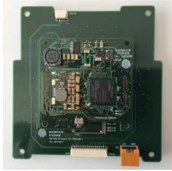
図2：6方向同時撮像カメラシステムの画像取得処理部の写真
