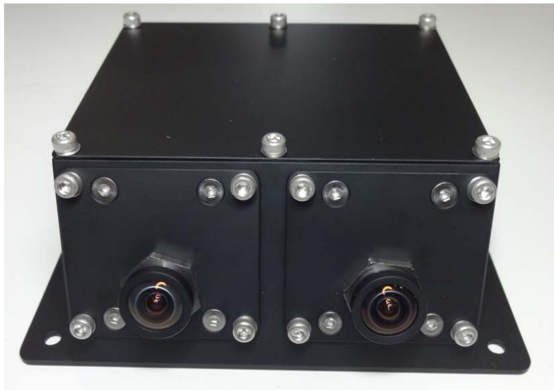
図2：デブリセンサ監視用カメラ
