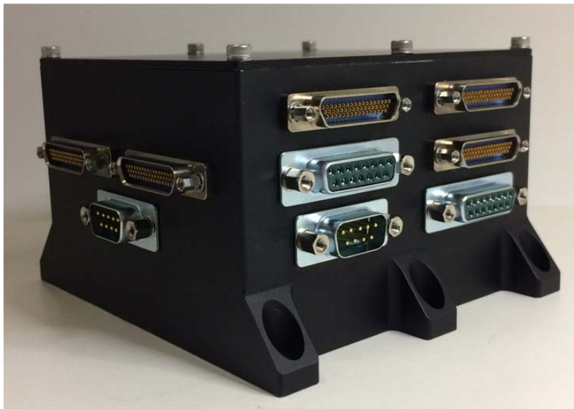
図1：IDEA OSG 1 主搭載計算機
