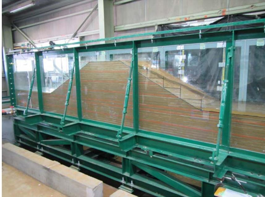
★地震発生実験では上記、接続部（水路）に空圧式加振装置を装着
