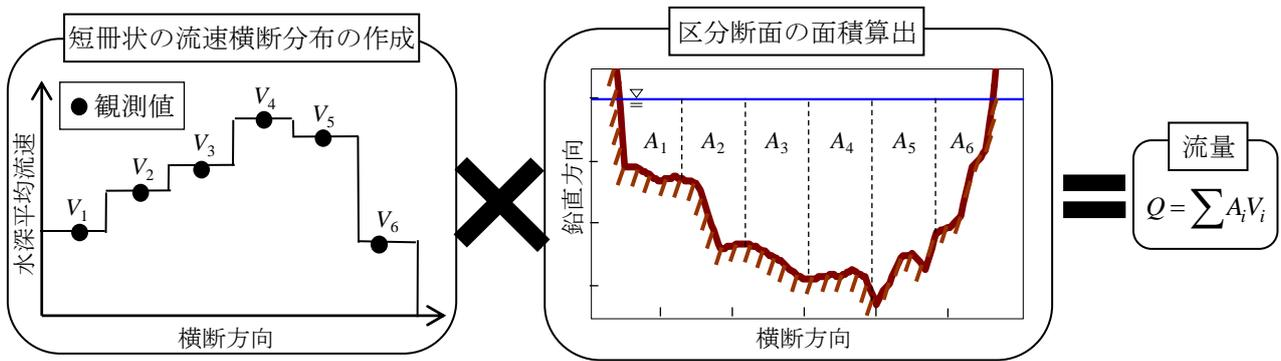
図2 従来の流量算出方法（区分求積法）
