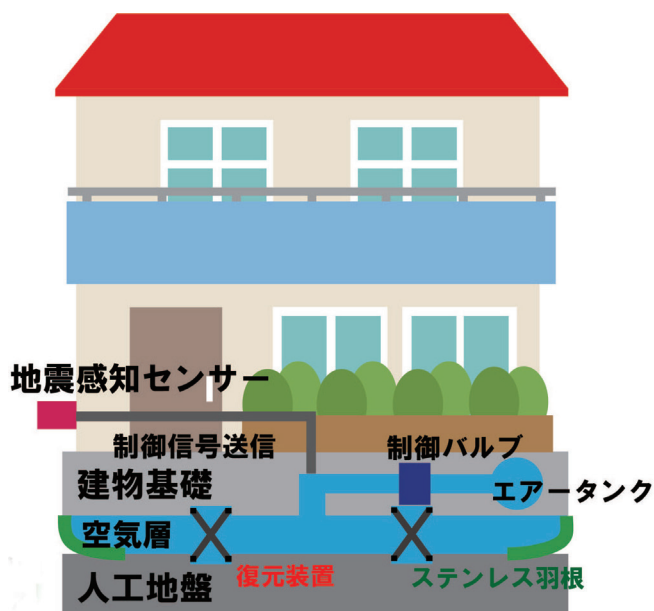
空気浮上免震の構造システム
