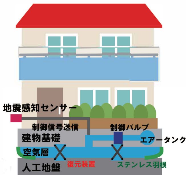
空気浮上免震の構造システム
