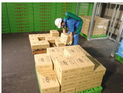
装着型の「腰部補助用マッスルスーツ®/標準モデル」
