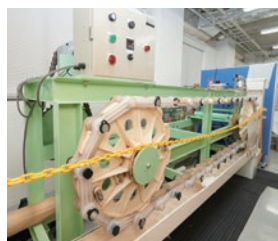
水処理施設用汚泥掻き寄せ機
