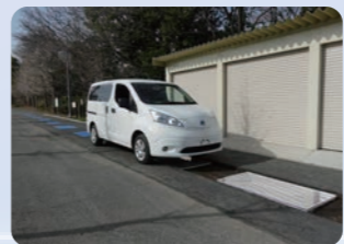
EV走行中におけるワイヤレス充電の実験
