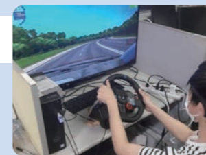
運転状況・脳波・表情を収集するドライブレコーダー実験
