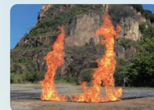
火災旋風の発生メカニズムに関する実験
