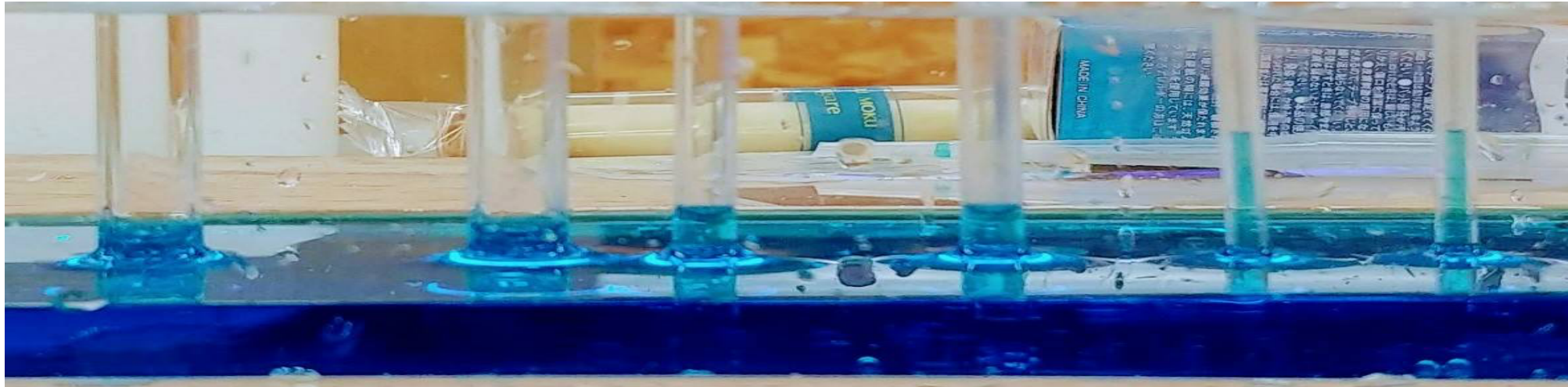
図2: 地上での様子 (内径は左から順に8.0 mm, 4.0 mm, 1.8 mmが2本ずつ)
