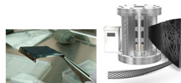
図2 高放射線耐性高効率発電用太陽電池(左)と高性能長寿命CFRPフライホイールバッテリー試作イメージ(右)
