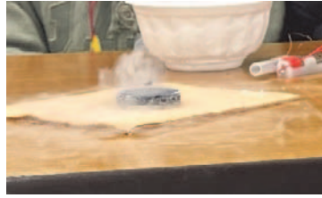
液体酸素・超伝導体磁気浮上の実験：後藤 穰 准教授
