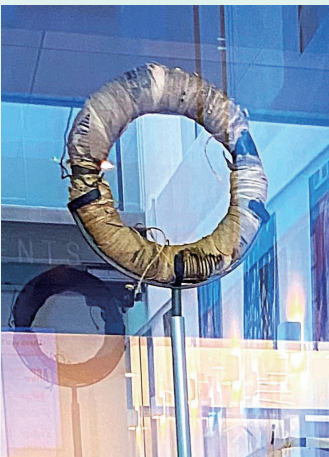
図2 ファラデーが電磁誘導の発見に使用した電磁石コイル。王立研究所の博物館に常設展示されている。 (2025年3月筆者撮影)
