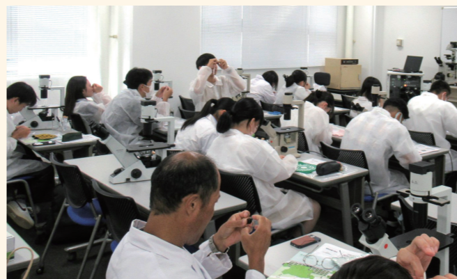
スマホ顕微鏡の作製 参加者に1.5mmのガラスビーズを配り、それを小さな穴を開けたプラスチック板に挟んでレーヴェンフック型の単レンズ顕微鏡を作り、これをスマートフォンのセルフイーレンズ部にテープ固定し、スマホ顕微鏡を作った。
