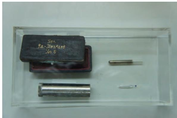
(図 5) 右下:一次ガラス管（ラジウム線源が封入外径 3.2mm、長さ 23mm、肉厚 0.27mm）、右上: 二次ガラス管（ここに一次ガラス管が収納。長さ 50mm 放射線の影響で発色）、左下: ガラス管を収納した鉄製の保護容器（外径 25mm、長さ 80mm）、左上:ラジウム副原器の No8 外箱。
