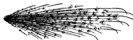
破裂は小さな複雑な破裂となり、数が多い。 流線は短く、赤みを帯びる。 約0.6~0.8% C鋼 (C 0.74 Si 0.24 Mn 0.33) (図5) 鋼:炭素が0.7%程度
