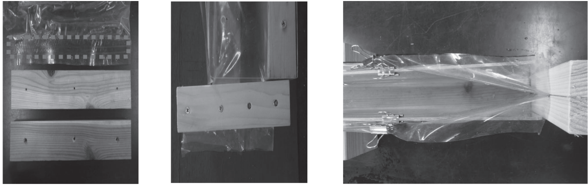
図 1 左：二つ折りにしたビニールシートの端部の熱着シールの状況（破線部分） 中：木材による挟み込み処理をした水バッグ端部がパネル端部に密着する状況 右：上から見下ろした挟み込み部分からパネル密着部にかけたの水バッグの状況
