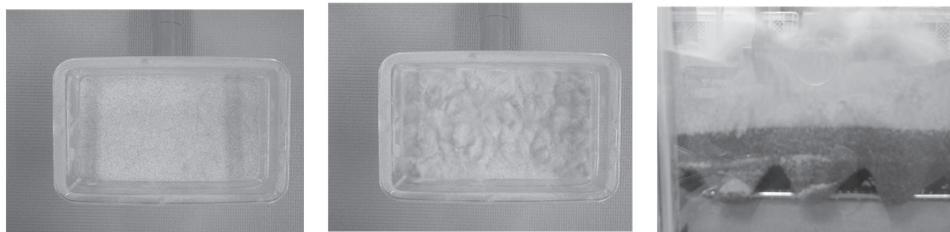
図 2-6 多孔層の上に敷き詰められた砂層(左)、送気により流動中の砂層(中・右)
