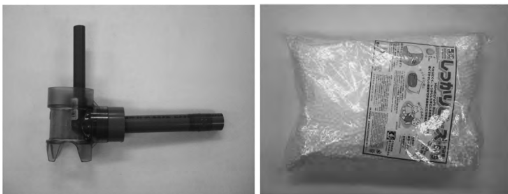
図3(続) E: 試料導入部に噴気管をセットした状態、F: 市販の発泡スチロール小球(2L)
