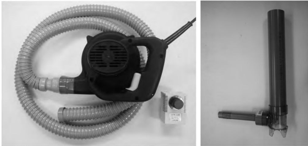
図3 各部の写真 A：ブロワーと送気管と変圧器、B：噴出装置本体
