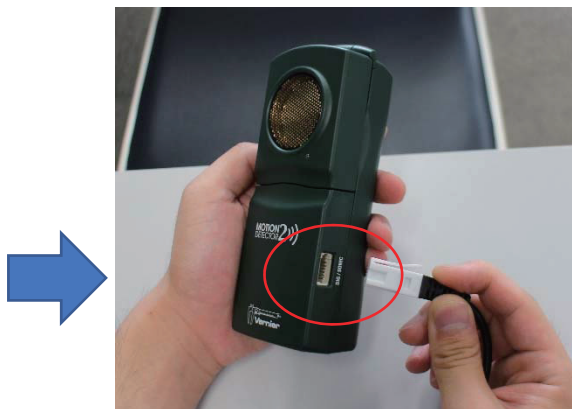
図 8 距離センサー側の差込口
