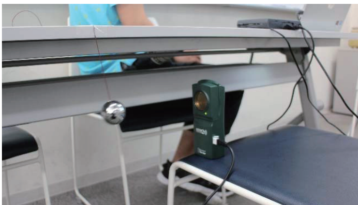
図 4 振り子の運動の計測の様子
