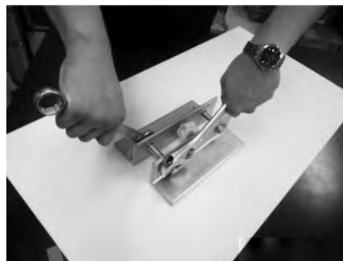
図5 L字金具を用いた簡便な岩石挟割装置
