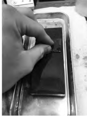
図 15 人造砥石による岩石の研削の様子
