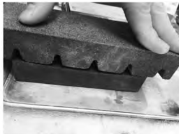
図 16 消耗した砥石の面出し用の修正砥石（左）と修正の 様子（右）
