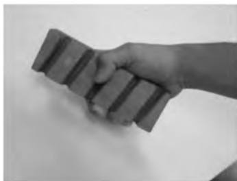
図 16 消耗した砥石の面出し用の修正砥石（左）と修正の 様子（右）
