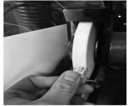
図11 両頭グラインダーによる岩石の研削の様子
