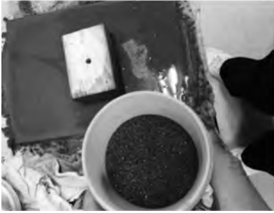
図 13 手摺りに使う研磨（研削）板と研磨粉（左）および研磨中の 図 14 手動研磨の際にプレパラート 治具の様子（右）
