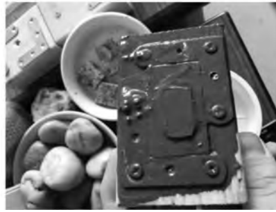
図 13 手摺りに使う研磨（研削）板と研磨粉（左）および研磨中の 図 14 手動研磨の際にプレパラート 治具の様子（右）
