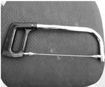
図10 金鋸の歯を岩石用に交換した岩石鋸と切断の様子
