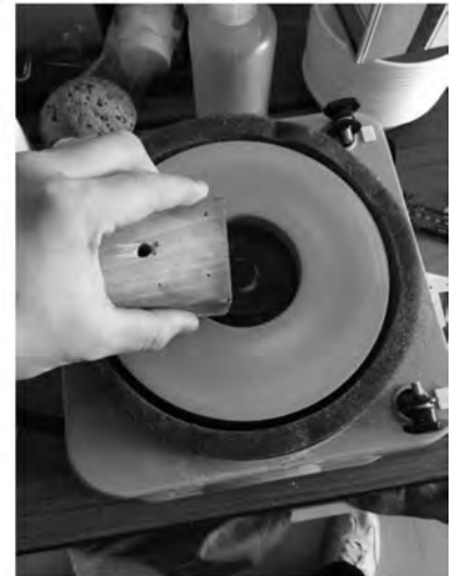
図12 電動研磨機による岩石の研削の様子
