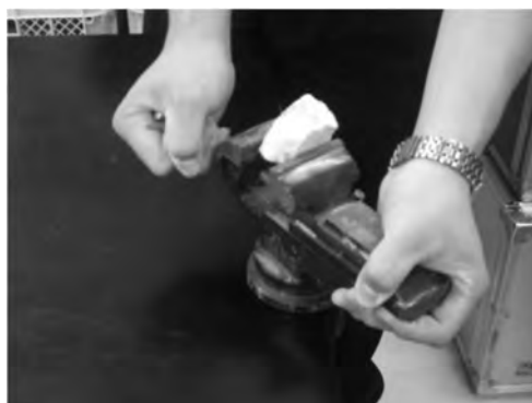
図4 万力を用いた岩石の挟割
