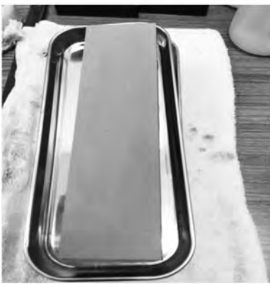
図 15 人造砥石による岩石の研削の様子
