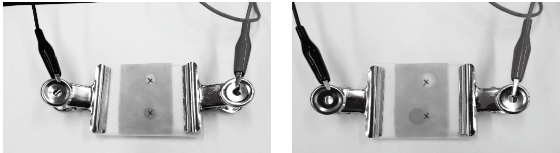
図6 紫キャベツパウダー溶液を使用した実験の結果 (左：綿棒を付着させた直後 右：綿棒を付着させてから4分後)
