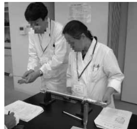
図 19 音叉の波長を求める実験の様子
