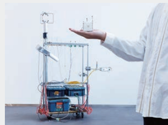
手のひらの上にあるのが、熱中症リスクを見える化する超小型センサ。
