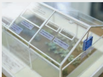
酸化ニッケル系太陽電池の特徴は透明であること。紫外線だけを吸収して発電します。
