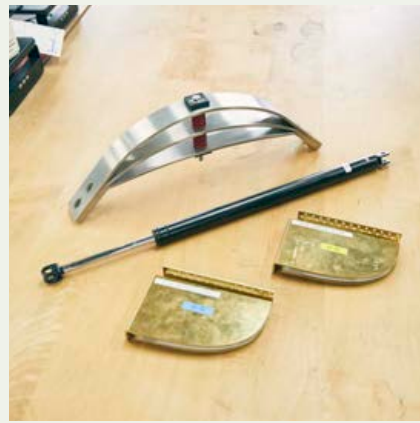
オイルダンパー(中)など、免震や制振のためのデバイスを多数開発。
