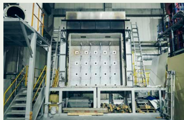
火災科学研究所実験棟にある壁材の耐火試験装置。
