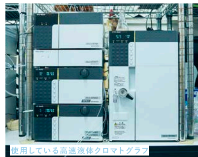
使用している高速液体クロマトグラフ
