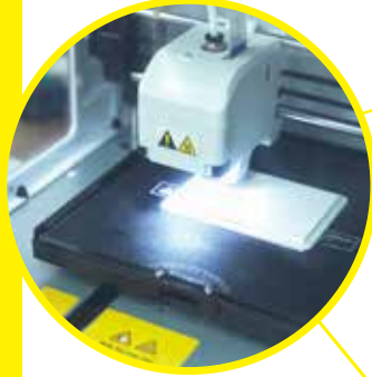
Pick Up! さまざまなデバイスの試作に使用する 3Dプリンター
