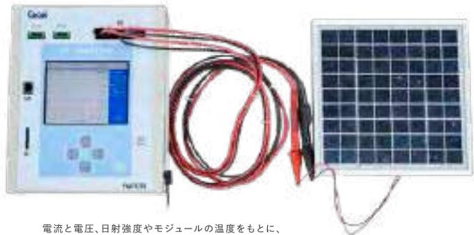
電流と電圧、日射強度やモジュールの温度をもとに、出力量や発電特性を分析
