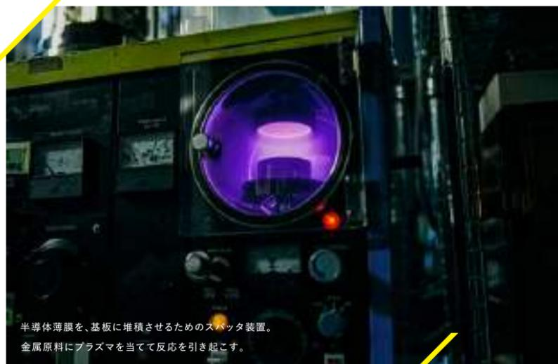
半導体薄膜を、基板に堆積させるためのスパッタ装置。
