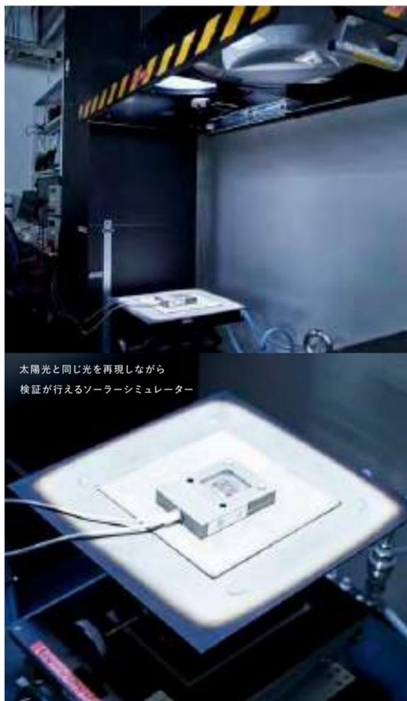
太陽光と同じ光を再現しながら検証が行えるソーラーシミュレーター
