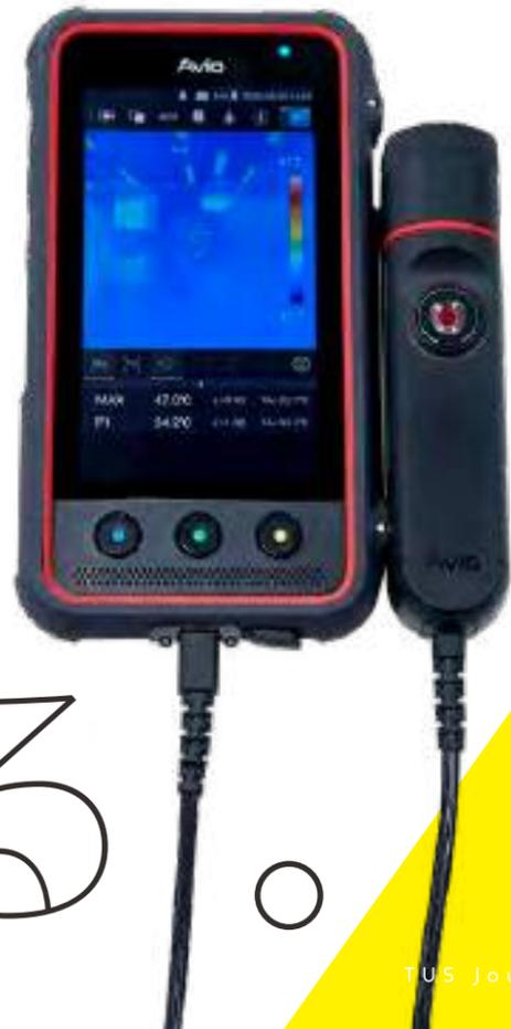
太陽光パネルの異常発熱などを検知するための赤外線サーモグラフィカメラ
