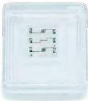
透明太陽電池で供給した電力で動作する、二酸化炭素を検知するワンチップ型透明半導体ガスセンサ。得られるデータを使って、植物の光合成を最適にコントロールする。
