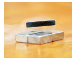
ある種の酸化物を液体窒素につけて低温にすると、超電導現象が起きる
