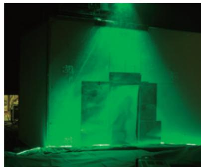
火災時の煙の流れを測定する実験
