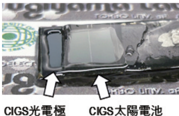
【図3】 水に沈めるだけで水素が生成する，CIGS モノリシック光電極 3) 。
