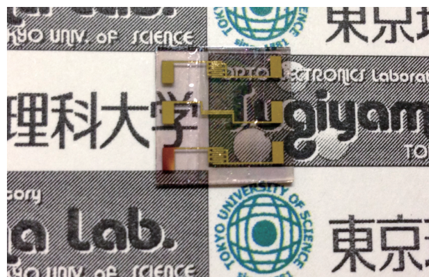
【図4】 透明太陽電池と透明二酸化炭素センサを積層したモノリシック透明IoT デバイス 4) 。
