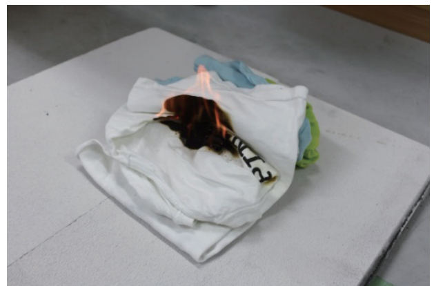
【写真2】 タバコ火災における燻焼から有炎燃焼への遷移。Tシャツの上にタバコを置いたところ、まず燻焼領域が拡大し（上の写真）、その後、有炎燃焼へ遷移する（下の写真）
