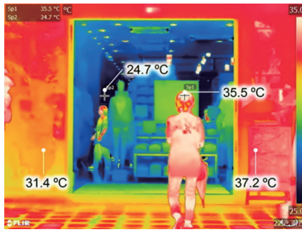
近年増えているエアカーテン。空気の壁を作り外気の侵入を妨げることで、店舗内の空調エネルギーが逃げないようにする
