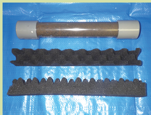
【写真 1】上：C 塩ビ製パイプの中に G 砂礫を充填し両端を D エンドキャップで塞ぐ 下：B カットしたスポンジの上面と側面
