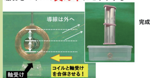
磁石をコイルの真ん中にセットする
