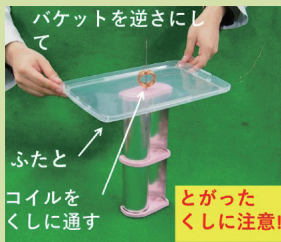
磁石をコイルの真ん中にセットする
