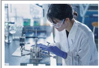
【図4】高圧反応容器の蓋を閉めて反応の準備をしている様子
