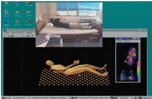
【図2】 分布圧力センサによる臥床モニタシステム
