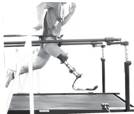
【図6】 フォースプレート内蔵トレッドミルを用いたスポーツ用義足の評価実験の様子。
