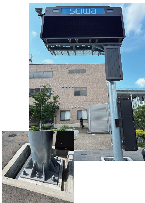
道路情報板の実物大模型 上部の情報板の重さが振動の大きな要因となり、接地部のボルトに大きな負荷がかかってくる
