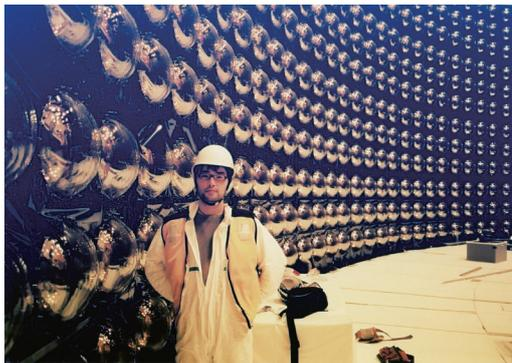
大学院生の頃。スーパーカミオカンデ内で作業をしているところ。壁面の電球のようなものは、光電子増倍管。
