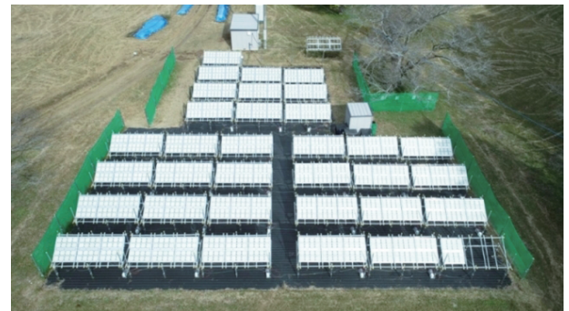
【図4】RhCrO x /SrTiO 3 :Al光触媒を用いた100 m 2 規模でのソーラー水分解による水素製造の実証試験
