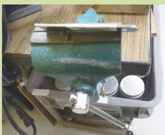
【写真4】万力に固定したE平折金具を押し倒して曲げ加工するところ。木片を当てて少しずつ押し出すと曲げられる
