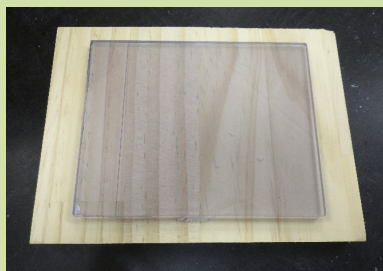
【写真1】C透明樹脂板(5mm厚の塩ビ板)とAベース用板材(集成材)
