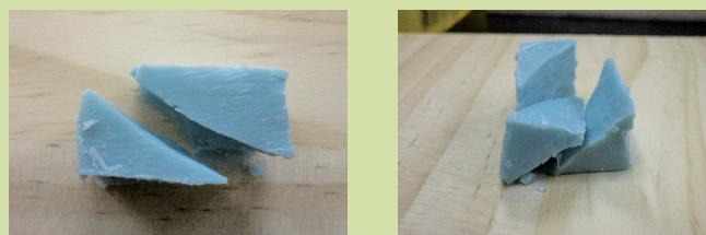
【写真7】圧縮された試料片は、寸法や形や向きによって、さまざまなパターンで変形する
