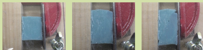
【写真6】セットした試料片に少しずつ圧縮力を加えると、始めは全体的に厚さが減るが、ある段階から特定の面で滑り始める
