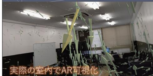
【図2】 室内の風をシミュレーションした結果(上)を、実際の室内にてAR(拡張現実)可視化する(下)。見えない気流の変化を容易に把握できる。(東京大学生産技術研究所・長谷川洋介教授との共同研究)
