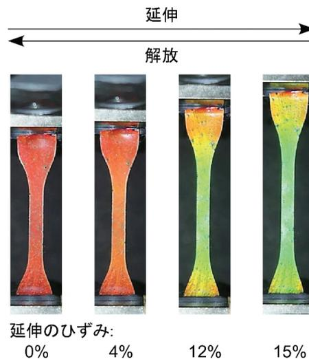
【図4】 柔軟なセルロース液晶ゴムを延伸した際の反射色の変化。
