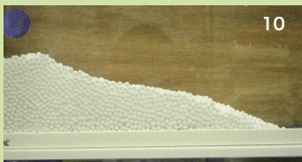
【写真10,11】 小球が大きな堆積体を造ってから、その「足元」に仕込んだ流動化発生装置を起動して、斜面を不安定化させる。安息角のかなり急だった斜面は、次々と崩れてなだらかな斜面へと変化する。
