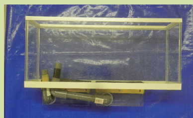
【写真3】 地形形成槽の側面。底部に装着された二つの箱状の装置は流動化発生装置で、送気管が接続される。噴出装置設置槽と同一の水槽を用いることで、上下にピッタリ重なる。
