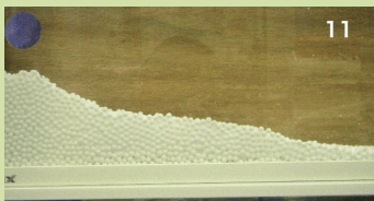
【写真10,11】 小球が大きな堆積体を造ってから、その「足元」に仕込んだ流動化発生装置を起動して、斜面を不安定化させる。安息角のかなり急だった斜面は、次々と崩れてなだらかな斜面へと変化する。
