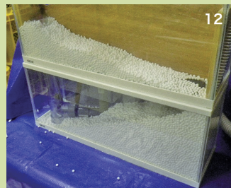
【写真12】 流動化発生装置を作動させて斜面が崩れていくときの俯瞰。崩壊した小球の先端部は、画面の右端のスリットから、下の槽へ落下する。
