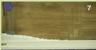
【写真6,7,8,9】 噴出装置から噴出された小球が徐々に地形形成槽内に堆積していく様子。堆積体が一定の大きさに達すると、その斜面は一定の斜度（安息角）をなすのでプリンの断面様の形となる。
