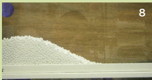
【写真6,7,8,9】 噴出装置から噴出された小球が徐々に地形形成槽内に堆積していく様子。堆積体が一定の大きさに達すると、その斜面は一定の斜度（安息角）をなすのでプリンの断面様の形となる。
